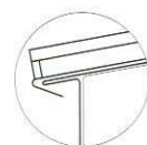
Ukončení okapnice, kolmé (pouze pro opticky nenáročné oblasti použití)
