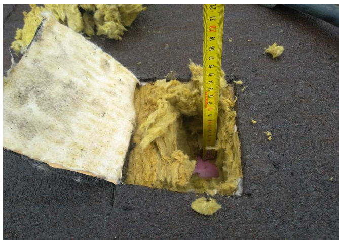
foto/7/ Pohled na provedenou sondu S2
